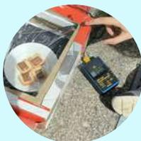
Medição da temperatura no interior de um forno solar
